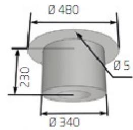
Des coupelles de diamètres différents sont fournies. Il suffit simplement de choisir la coupelle adaptée au diamètre de raccordement.
