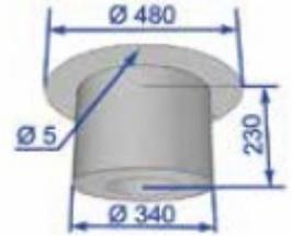
Des coupelles de diamètres différents sont fournies. Il suffit simplement de choisir la coupelle adaptée au diamètre de raccordement.
