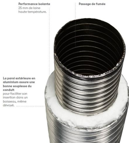
Les appareils de dernière génération génèrent des températures de fumées de plus en plus basse, pénalisant le tirage. En évitant le refroidissement des fumées, sur toute la longueur du conduit, VELA améliore le tirage et l'évacuation de façon conséquente.
